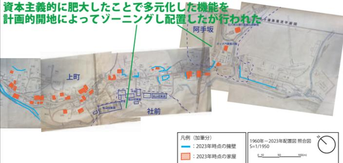
鉱山村落構造の変遷とは、元来の伝統的形態が社会的分化する近代化の過程が純に映し出された空間的現象である。近代尾小屋における半自動的鉱業生産の循環構造（従事者の増加→銅生産量の増加→資本の増加→居住者の流入→社会的機能の分化→開地の必要性→産業の興隆→従事者の増加→…）の起点は、開地による鉱山村落の空間的容量の増設拡張の必要性の力学であった。そして以上の需要の充足を担った土木の構造材こそが鉱滓煉瓦であったことが明らかになった。さらに同材が、**銅生産量の増加に比例して排出される残滓によって成形される特質を有することが、鉱山業下における循環構造を完璧に成立させたことがわかった。**
