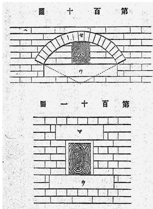
図 4.9 『建築学階梯』に示された梁の挿入方法
