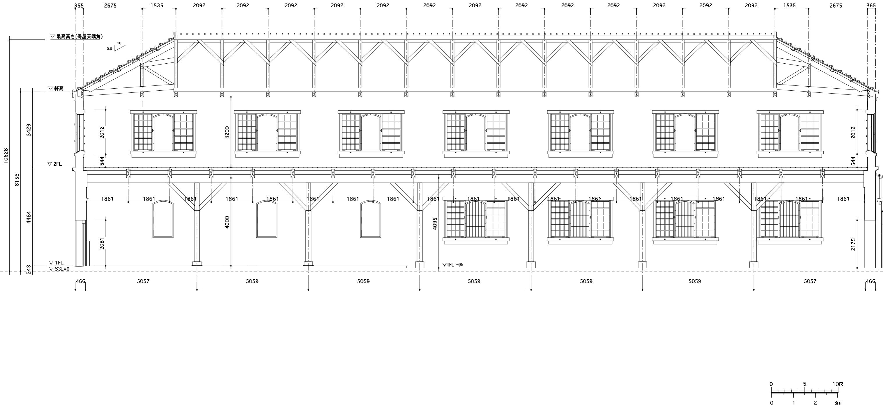
図9 煉瓦倉庫 X断面図 (1:100)
