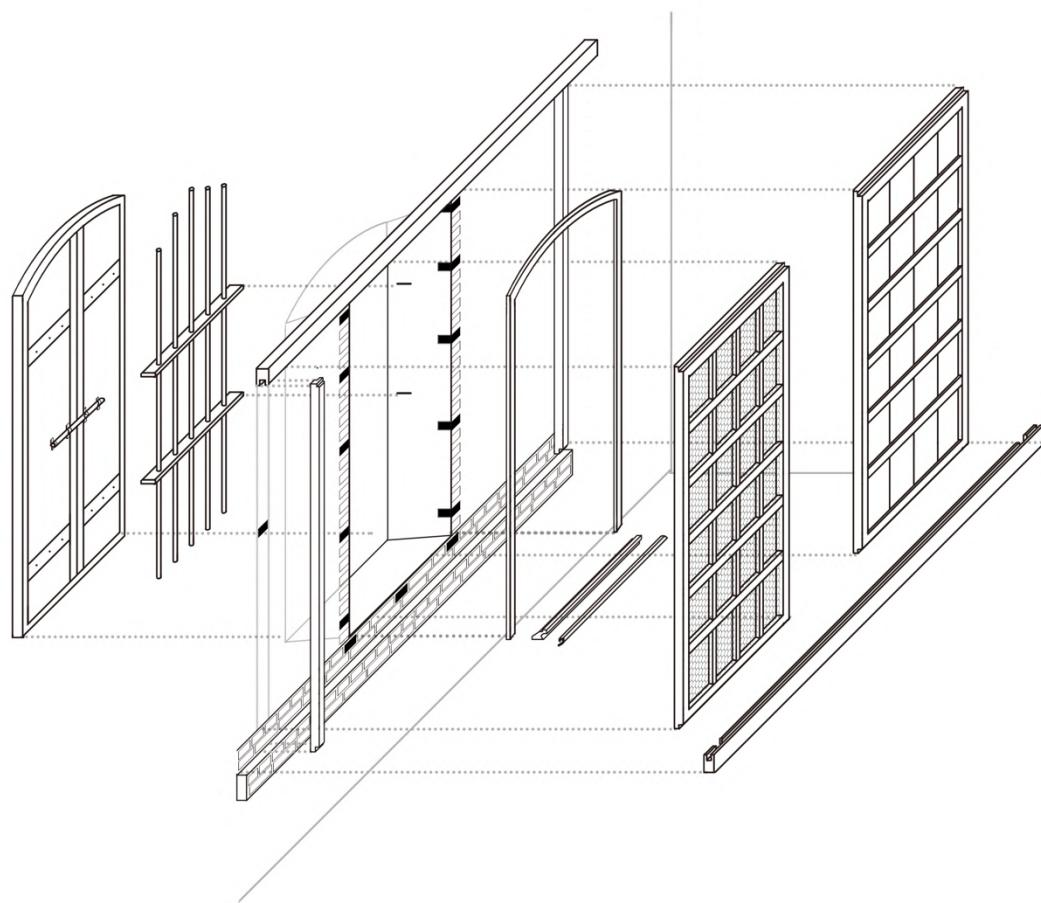
図 2.3 煉瓦壁部と建具の取り付けられ方
