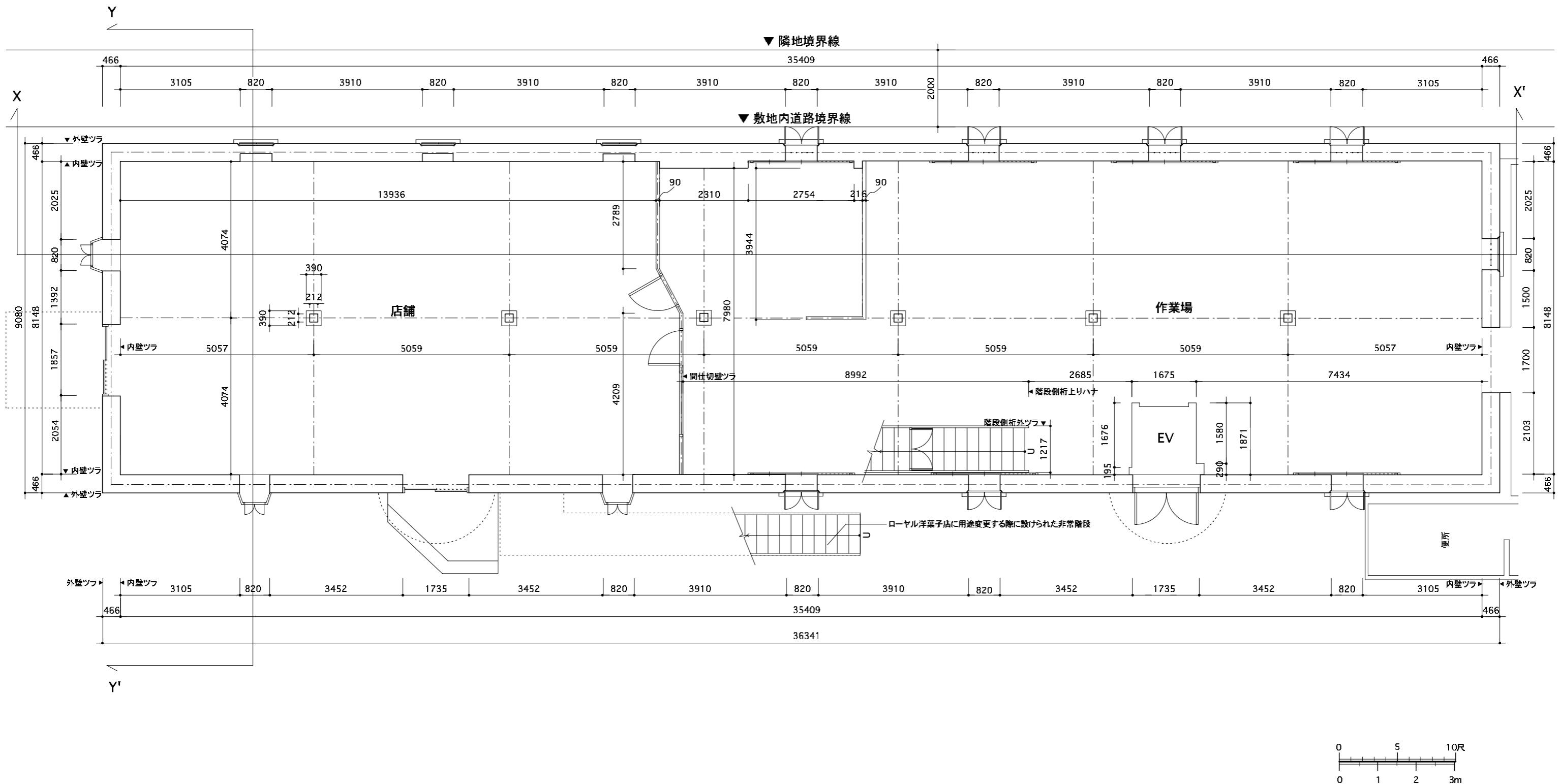
図2 煉瓦倉庫一階 平面図 (1:100)
