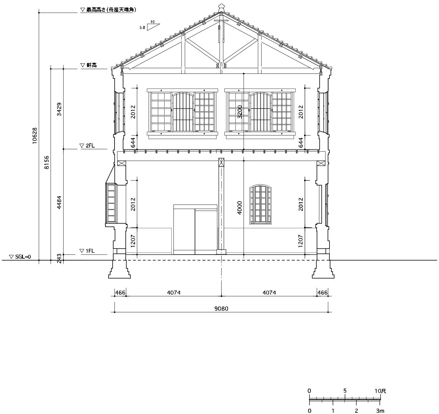
図8 煉瓦倉庫 Y断面図 (1:100)
