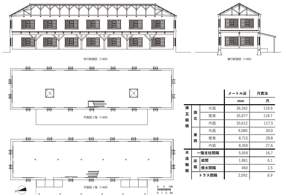
図 4.2 旧本庄商業銀行煉瓦倉庫の各種寸法
