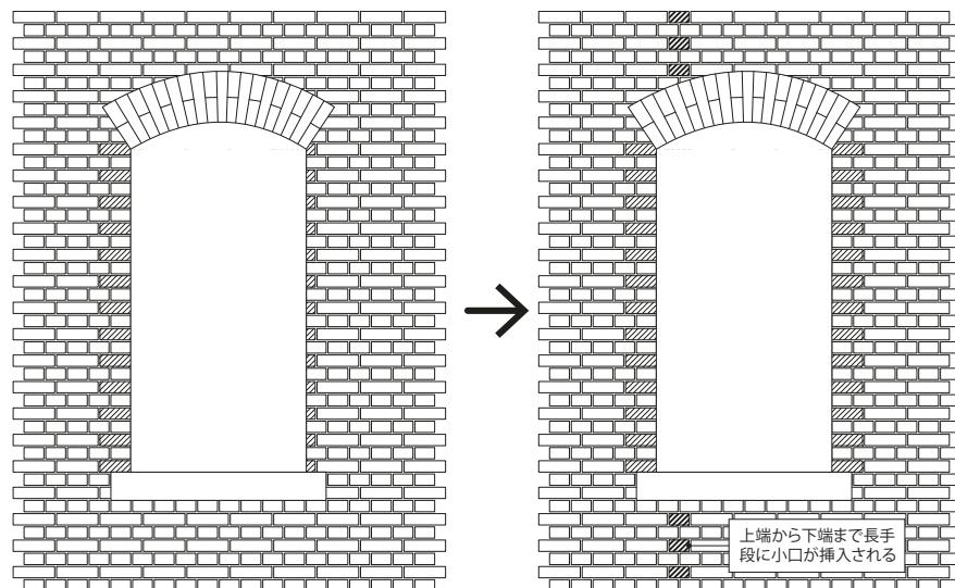
図 4.5 旧本庄商業銀行煉瓦倉庫における小口煉瓦の挿入方法
