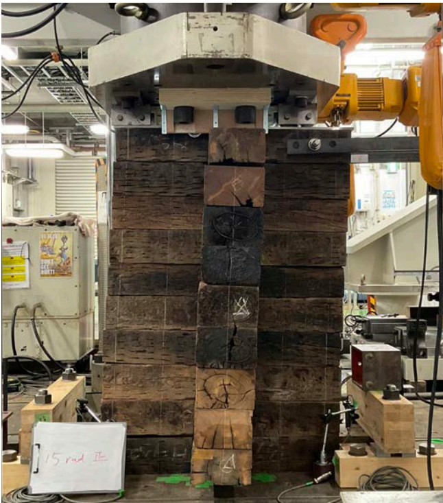
竖向荷载 100kN，层间变形角 1/15\text{rad} ，负方向
