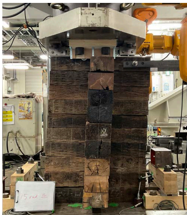
鉛直荷重 100kN, 層間変形角 1/15\text{rad} , 負側
